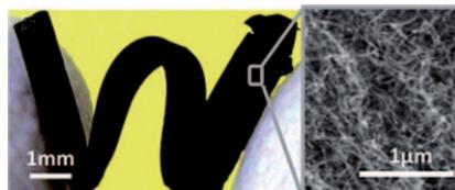
**Extrem elastisch:** Kürzlich wurde ein neues viskoelastisches Material aus Kohlenstoffnanoröhren entwickelt (CNT-Kautschuk, siehe Bild). Das Material ähnelt Silikonkautschuk, bewahrt seine Viskoelastizität in einer sauerstofffreien Umgebung jedoch in einem Bereich von  $-196$  bis  $1000^{\circ}\text{C}$ . Es bietet Möglichkeiten für zahlreiche Anwendungen, z. B. in Hochvakuumöfen und sogar für Weltraumfahrzeuge zur Reise durch den kalten interstellaren Raum.
